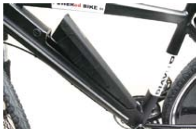
(3) 上側をフレームに当てないようにずらして下側を外します。
