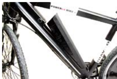
(2) フレームに当てないように注意しながら、下側から差し込みます。
