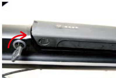
(2) キーを回してロックを解除します。
