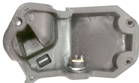
15. 后盖安装充电口，再安装防水圈
